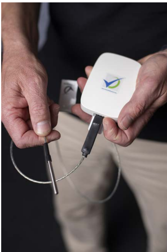
I kryotankar med flytande kväve, som används på IVF-kliniker och som ses här säkerställer PT100-sensorer rätt temperatur på -196 °C. Avvikelse temperaturen larmar ICU:s system Boomerang att kväve behöver fyllas på.
