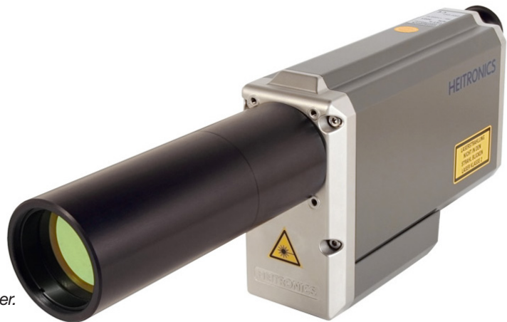
Capella C3 från SensorTherm är ett exempel på en kvot-pyrometer.
