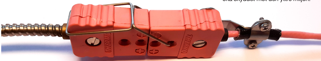
Termoelementskarv med hon- och hankontakt samt låsbjgel (clips) i funktion.
