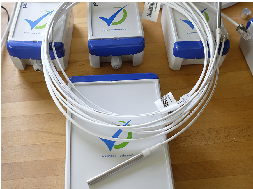
Givaren är en specialvariant tillverkad av Pentronic, som levererar digitala signaler till noderna i det trådlösa mätsystemet Boomerang.
