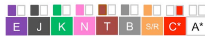
Figur 3. IEC 60584 (2013) innehåller 10 olika termoelementtyper som identifieras med färger där så är möjligt. *) Typerna C (WRe5-WRe26) och A (WRe5-WRe20) har tagits upp i standarden men färgkoder är såvitt känt inte fastställda ännu. Koden för typ C i figuren är den som anges i defacto-standarderna.
