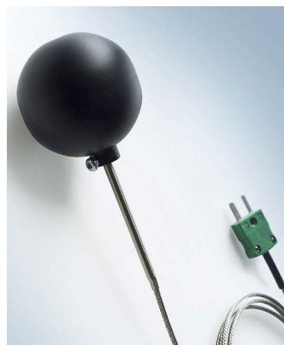
Exempel på en globtermometer (50 mm), här med ett termoelement instuckat till globens centrum. Globtermometern monteras fritt i luften.
