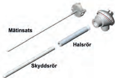
Figur 1. Typisk uppbyggnad av termoelementtyperna R, S och B. Mätinsatsen innehåller ädelmetalltråd med diameter 0,5 mm för längre drifttid. Den keramiska insatsen skyddas av ett yttre bottnat keramiskt rör. En hals i stål ger stadga och fäste för klämförskruvning, fläns eller liknande.
