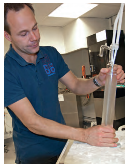
Laboratoriechefen Lars Grönlund aktiverar trippelpunkten för vatten. Pentronic erbjuder spårbarhet till temperaturskalan ITS-90 på flera olika sätt.
