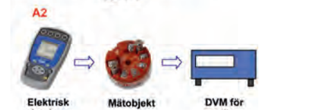
Metod A. Kalibrering av temperaturgivare och transmittor var för sig. Givaren kalibreras i temperaturstabil värmekälla och transmittorns insignal simuleras med en processkalibrator. Upplösningarna motsvarar \pm 0,01 °C i alla instrumenten.
