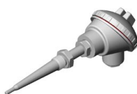
Figur 2a. Processgivare monterad i konisk dykficka med reducerad spets. Mätinsatsen är \varnothing 3,0 mm och hålet i fickans spets \varnothing 3,1 mm. Givaren används bl a för debiteringsmätare i fjärrvärmesystem.
