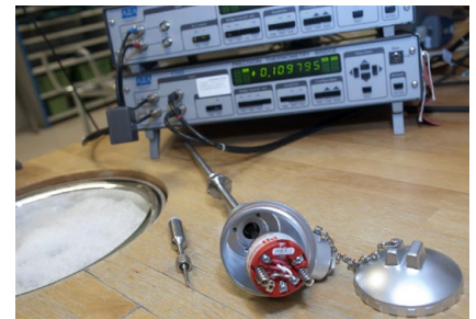
Samtrimning av givare och transmittor är en allt mer efterfrågad tjänst. T v Pentronics nya givare med integrerad transmittor, t h en konventionell givare med transmittor i kopplingshuvudet.
