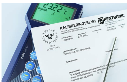
Figur 1: Swedac-märket "kattfoten" längst upp till vänster på kalibreringsbeviset talar om att kalibreringen är utförd under ackreditering. Andra länders ackrediterade kalibreringsbevis gäller i Sverige och omvänt.
