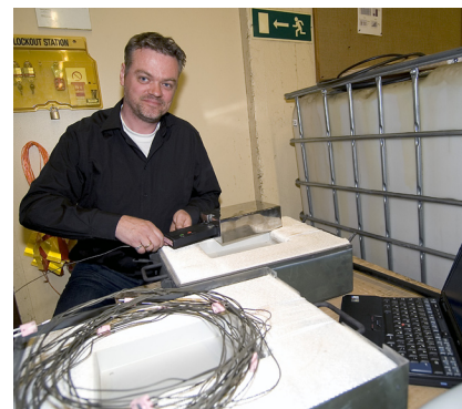
Patrik Stender visar loggern och den skyddande barriären som klarar även Bodycotes hetaste process på 1150 °C.
