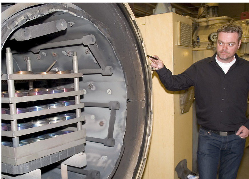
– Vi ställer in loggern i ugnen och tar ut data i realtid via radio, berättar Patrik Stender på Bodycote. Det är enda sättet att mäta i en vakuumugn utan att punktera håljet.
