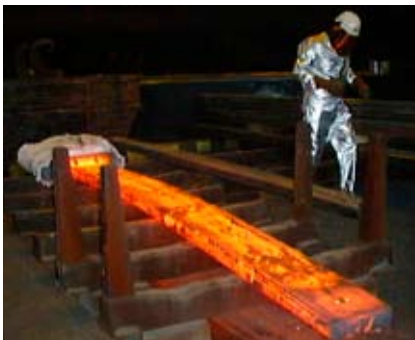
Pentronic har på kort tid levererat flera resande loggrar från Datapaq till svenska stålverk. Paketet på det glödande stålet är en barriär innehållande logger.
