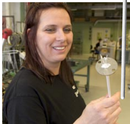
Figur 2. Termoelement av ädelmetalltyp måste kapslas i högren keramik vet Monica Gustafsson att berätta. Här visar hon en mätingsats som är avsedd för den intilliggande givaren med keramiskt yttre skydds rör.
