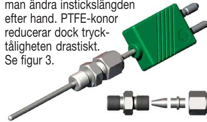
Figur 3. En trycktät genomföring kan underlätta monteringen av givare. Pentronics genomföringar består av kropp, kona, och i vissa fall tryckbussning samt överfallsnutt som ger klämkraft.
