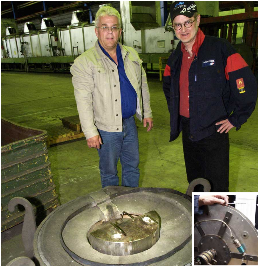
Thomas Ånger och Morgan Holst vid Ovako Steel i Hällefors konstaterar att den resande loggern tjänat ut. Elektronikheten placeras i en ficka mellan de inre värmebarriärerna. Infällt syns ett upprullat släp-termoelement som är den alternativa mätmöjligheten.
