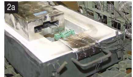
Loggern (2b) går att använda i höga temperaturer om den kapslas in i lådor med värmebarriärer (2a). Barriärernas uppgift är att fördröja värmens inträngande tillräckligt länge för att resan genom ugnen och mätningen ska hinna avslutas. Idag finns radioöverföring av mätdata för realtidsstudier.
