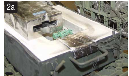
Loggern (2b) går att använda i höga temperaturer om den kapslas in i lådor med värmebarriärer (2a). Barriärernas uppgift är att fördröja värmens inträngande tillräckligt länge för att resan genom ugnen
