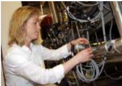
Givarna kalibreras i processen. De stränga hygienkraven gör det svårt att ta bort givarna för kalibrering i laboratorium.
