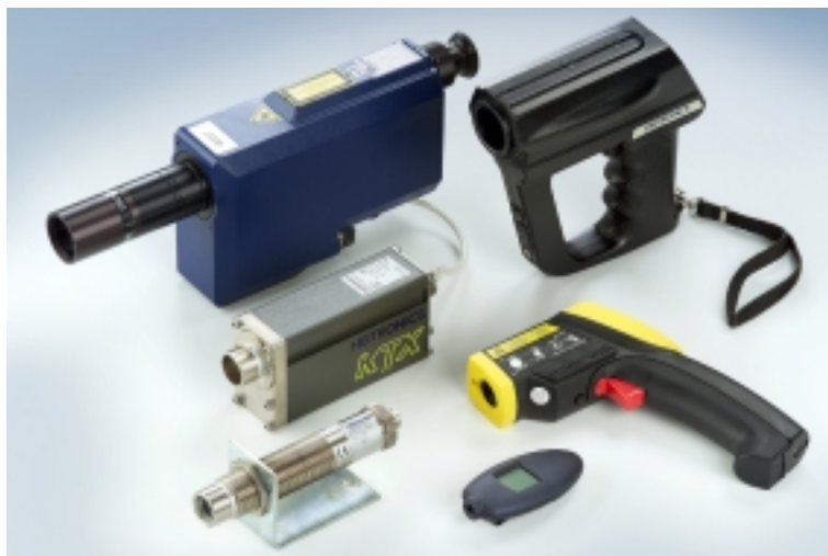
Exempel på pyrometrar. Under givna förutsättningar mäter pyrometern mycket bra och dess fördelar, snabb och beröringsfri mätning, gör den ofta till ett bra alternativ. Nackdelen är mätprincipen som kan vålla stora mätfel för den oinvidde.
