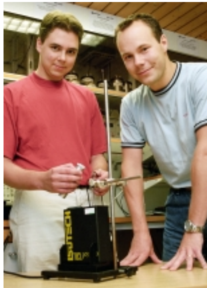
Måns Ackerholm och Lars Grönlund vid Pentronics kalibreringslaboratorium är eniga om att blockkalibratorn är ett bekvämt verktyg för kalibrering i fält. Under förutsättning att den är ordentligt kartlagd och kalibrerad.
