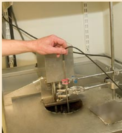
Det nya saltbadet är insynat med en total mätosäkerhet för hela systemet på ± 0,02 °C i temperaturer mellan 200 och 550 °C.
