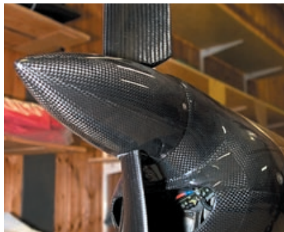
Kolfiberkomposit är ett starkt och lätt material som tillåter avancerade former. Den här propellern och motorgondolen sitter på motorsegelaren Windex som är ett ensigt flygplan.
