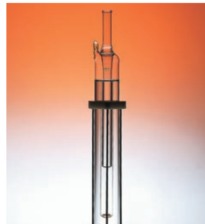
Trippelpunkten för vatten (0,01°C) är den fundamentala fixpunkten i temperaturskalan ITS-90 som definierar enheterna 1 °C och 1 K som är lika stora. Temperaturskalans nollpunkt (0 K alltså -273,15 °C) går ej att realisera fullt ut. Världsrymdens bakgrundsstrålning är mycket låg och uppgår till ett par grader K.
