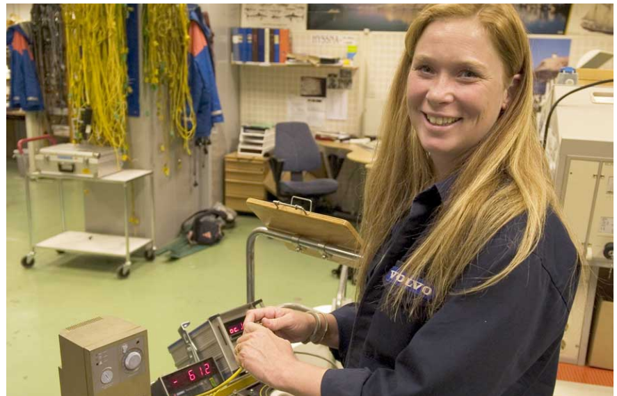
Annika Sandström och hennes kolleger kalibrerar hela mätkedjorna i Volvo Pentas provrum. För att marinmotorerna ska kunna ge 40-50 procent mer effekt än motsvarigheterna i Volvos lastvagnar krävs fullständig kontroll över mätutrustningen.
