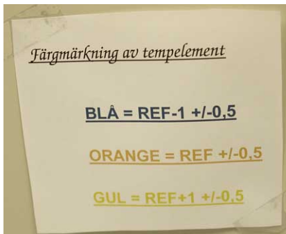
Volvo Pentas egna färgkoder för gruppering av termoelement K efter kalibrering: Blå: -1,5 < \Delta T < -0,5^\circ\text{C} . Orange: 0,5 < \Delta T < 0,5^\circ\text{C} . Gul: 0,5 < \Delta T < 1,5^\circ\text{C} .
