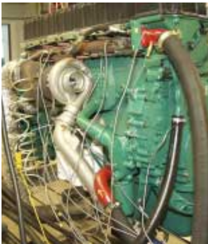
Alla givare kopplas in med multikontakter för att utbytet av motorer i laboriet ska gå snabbt.
