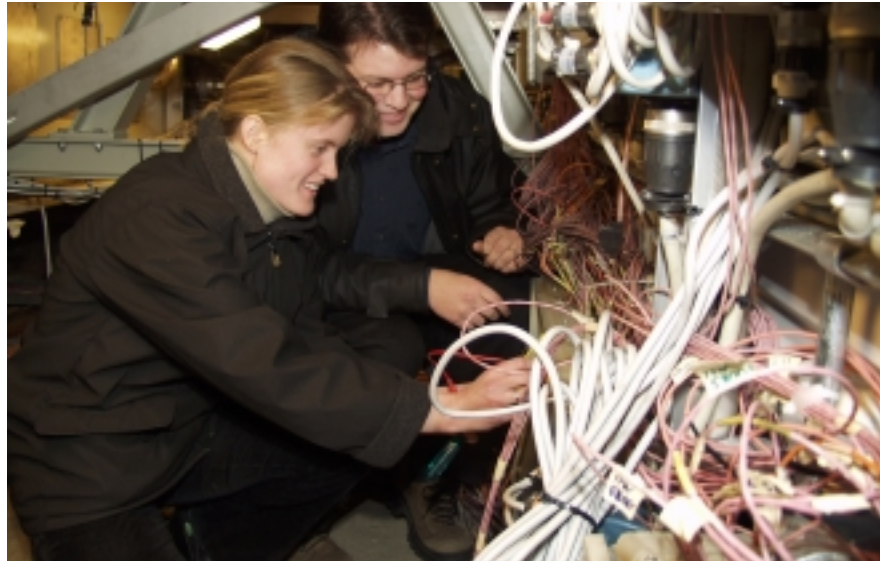
Viktoria Petrė Lindholm och Reine Lundqvist kontrollerar en bråkdel av de flera kilometer termoelement-tråd som används för prototyp-test av en gasturbin.
