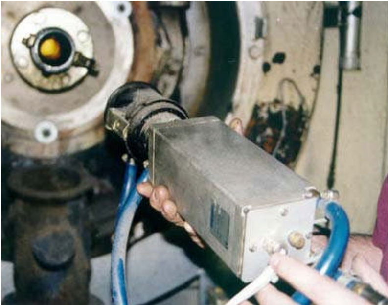
Exempel 4. En KT15.69 med rektangulärt formad kylanordning ska just monteras i sitt snabbfäste. Lågorna kan skådas genom det safirglasförsiglade siktröret.
