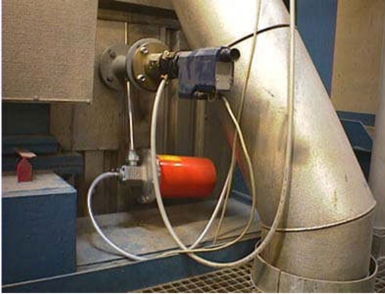
Exempel 3. KT19.69 med genomsikts-sökare, inbyggd temperatur-display och inställningsknappar.
